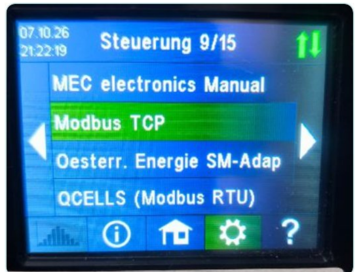
3 – Steuerung 9/15: Modbus TCP selected
