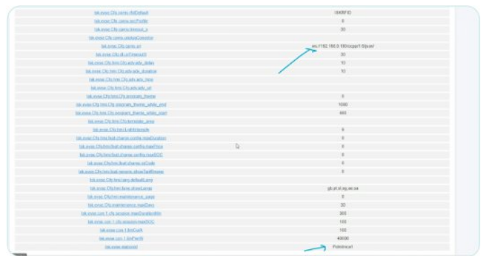
Parameters lsk.evse.Cfg.cpms.uri and lsk.evse.stationId
